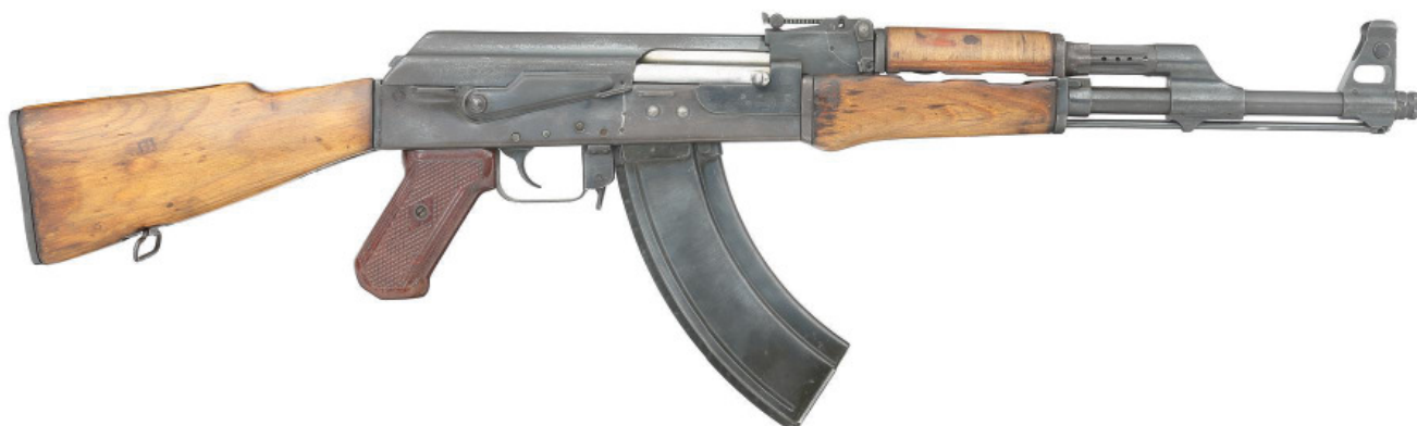
Bild 10 AK från 1951 med låda av stansad plåt
