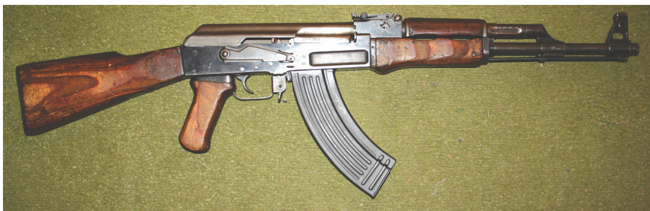
Bild 11 AK från 1951 med maskinbearbetad låda (lägg märke till urfräsningen ovan/framför magasinet)
