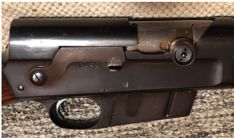
Bild 14 Browning/Remington Modell 8 med kombinerad säkring och smutsskydd
