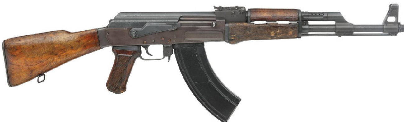
Bild 11 AK från 1951 med maskinbearbetad låda (lägg märke till urfräsningen ovan/framför magasinet)
