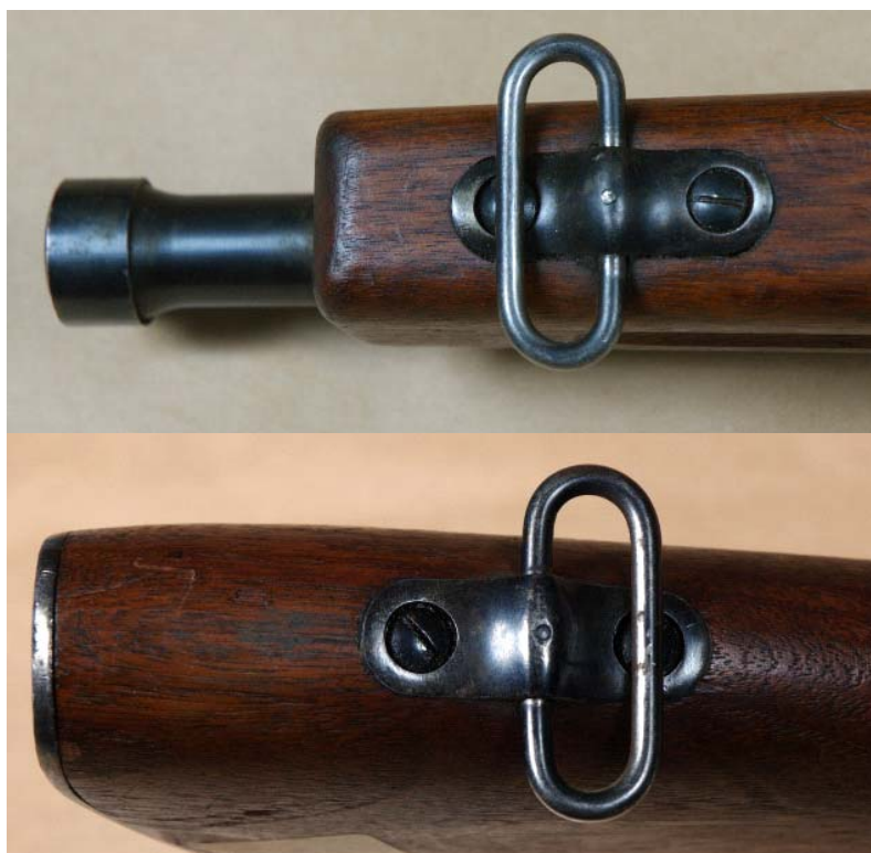
Fig. 8 ifrån Armémuseums samling. Rembyglar på kpist m/40 nr 12340. Lagg märke till hur framstocken är rakt avkapad.
