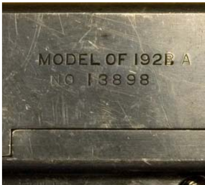
Fig. 7 Bild ifrån Armémuseums samling. Detalj av kpist m/40, tillverkningsnummer 13898, som visar ändringen av 1921 till 1928 och tillägget bokstaven A för att bilda MODEL OF 1928 A på vänster sida av lådan.
