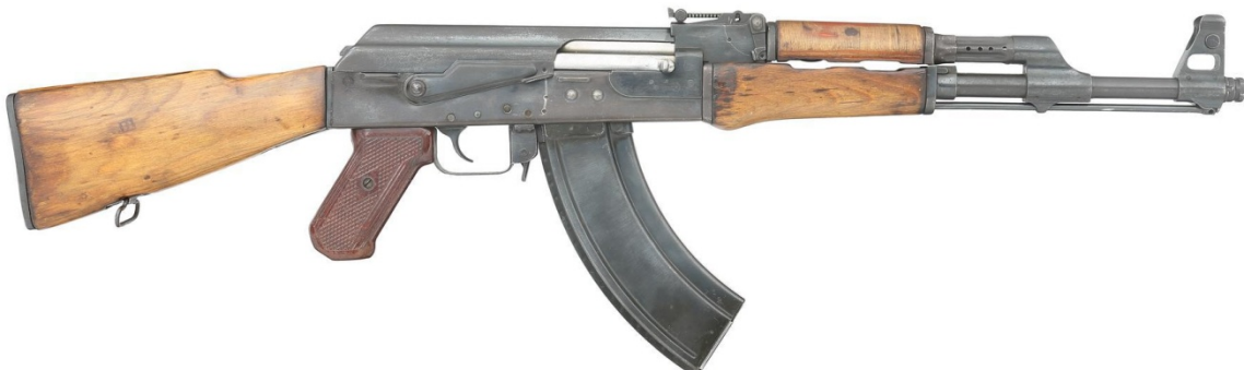
Bild 10. AK ifrån 1951 med låda av stansad plåt
