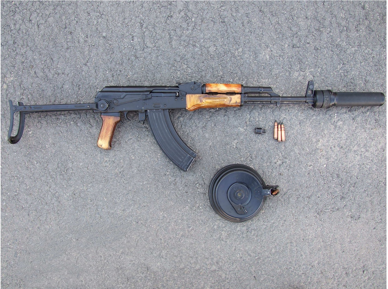
Bild 19. AKMS med en ljuddämpare av typen PBS-1 och ett RPD trummagasin som användes av Spetsnaz. Lägg märke till den lilla skedformade mynningsbromsen bredvid patronerna.
