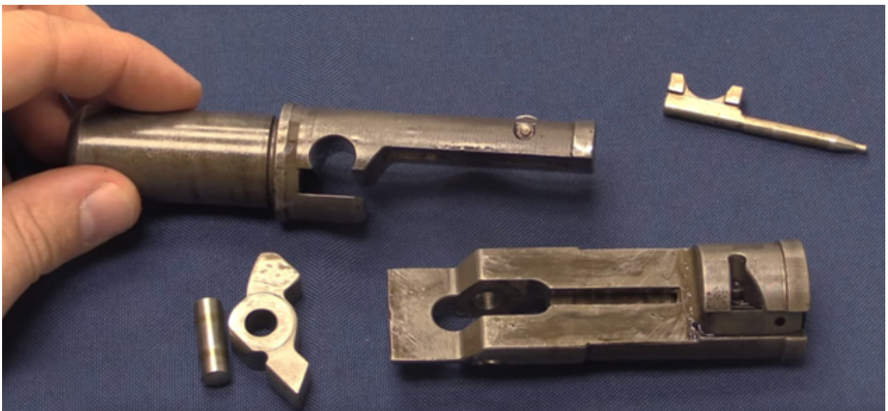
Bild 16. Den ungerska kpistens slutstycke med sin vipparm och bult konstruerad av Kiraly 39M (nederst till vänster).
