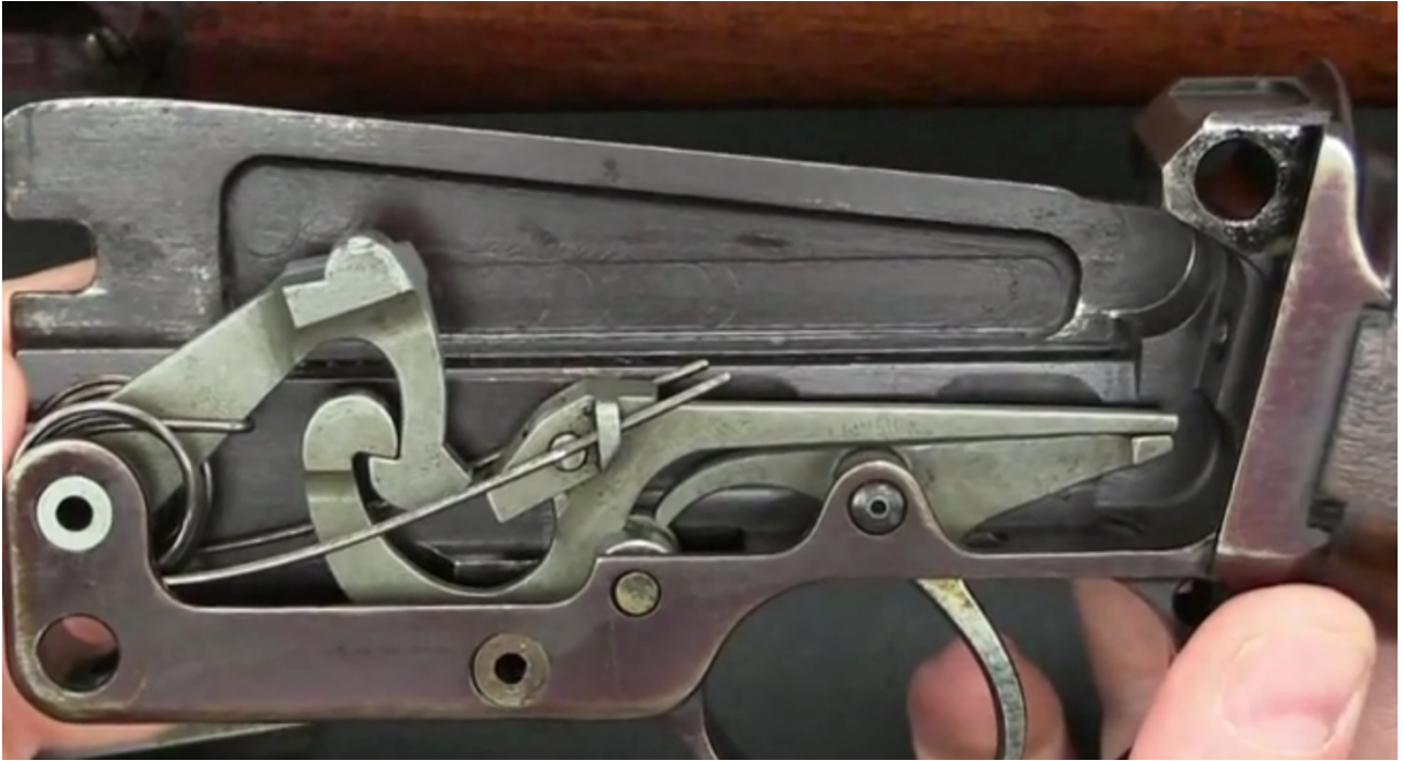
Bild 13. Tjeckoslovakiska ZH-29 avtryckarsystem som också påminner om Garands
