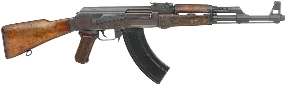
Bild 11. AK ifrån 1951 med maskinarbetad låda (lägg märke till urfräsningen ovan/framför magasinet)
